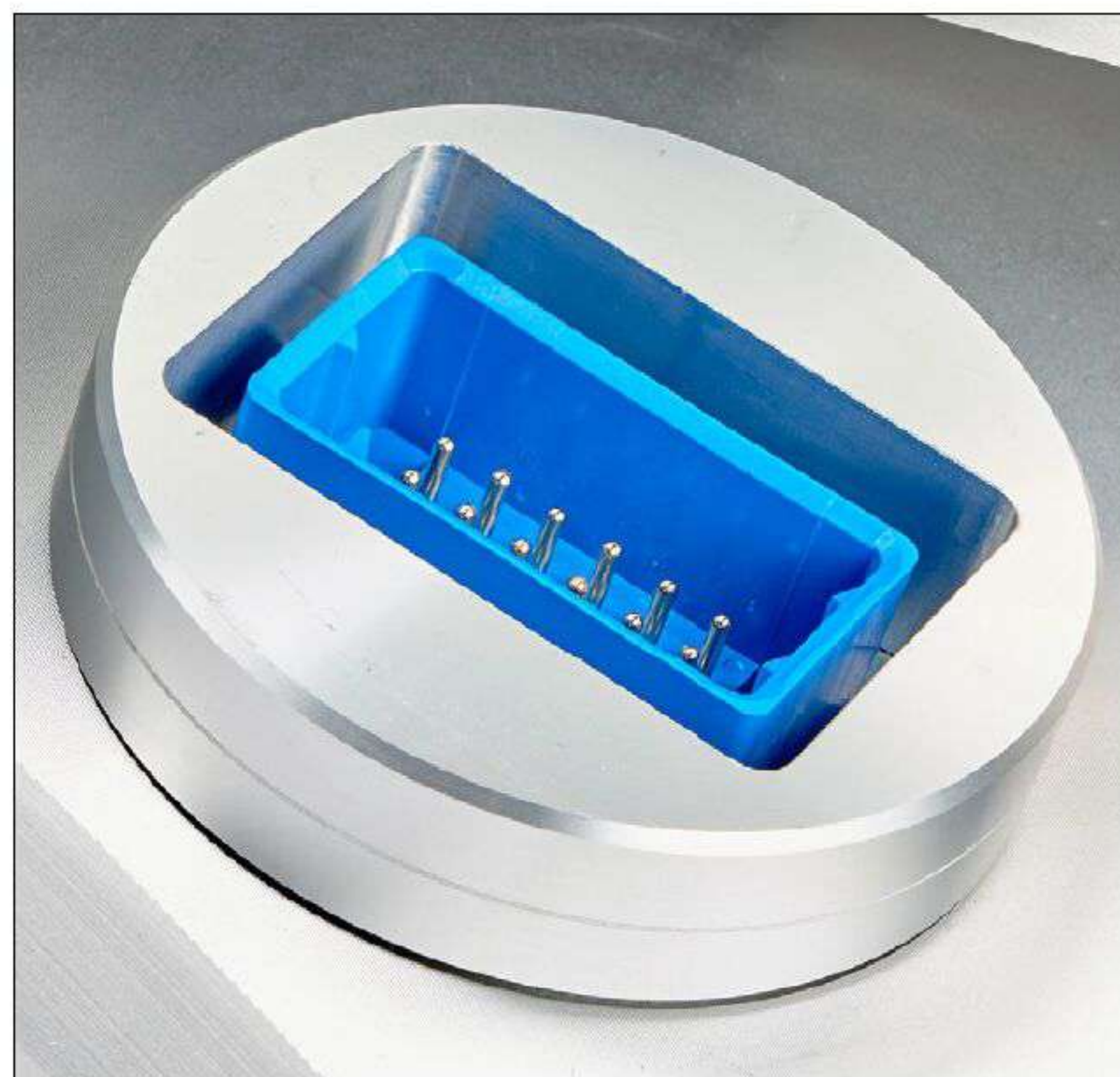
In der Stütze vorn rechts befindet sich versenkt die Kontaktbrücke zwischen Netzteil und Amp.
